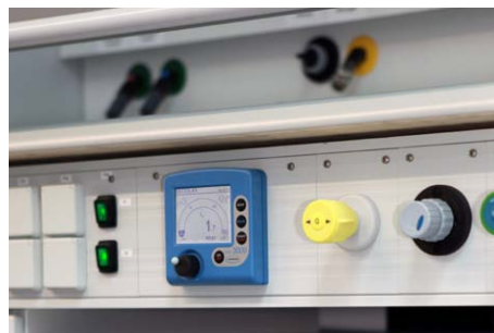
Línea VACUU-LAN® con controlador CVC 3000 E para control de vacío de la línea. Ahorra espacio la integración en los muebles de laboratorio.
