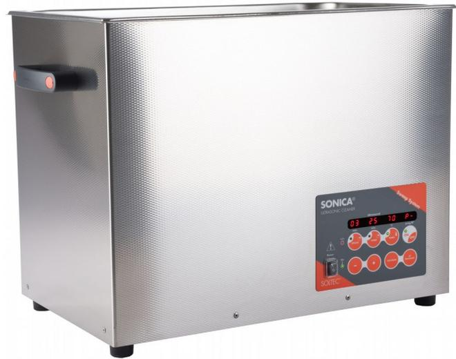
\* Cuba de acero inoxidable hecha en AISI 304 con un espesor 08/10 con las esquinas redondeadas para una mejor eliminación de los residuos después del proceso de limpieza.
