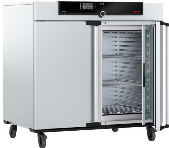
El sistema de calentamiento de este incubador está ajustado de forma óptima tanto para un sistema de convección natural como para un sistema de circulación de aire forzada. Por este motivo, el ventilador se puede desconectar por completo con el fin de calentar cargas muy valiosas con especial cuidado en los sectores farmacéutico, médico, de la investigación y la química de los alimentos.
